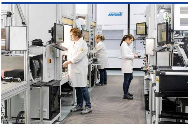
In der Kamerafertigung montierte Komponenten lassen sich durch die Maschinendatenerfassung zurückverfolgen.
