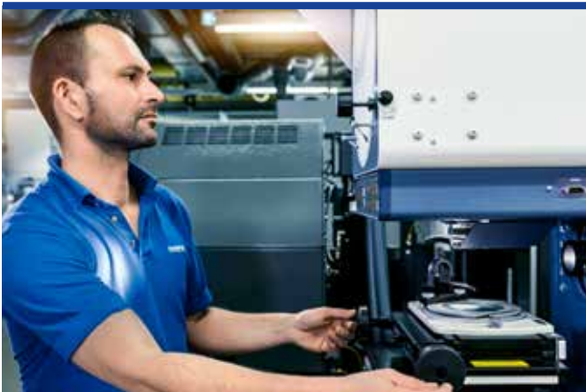
Olympus-Mitarbeiter prüft die Maße einzelner Komponenten am Profilprojektor
