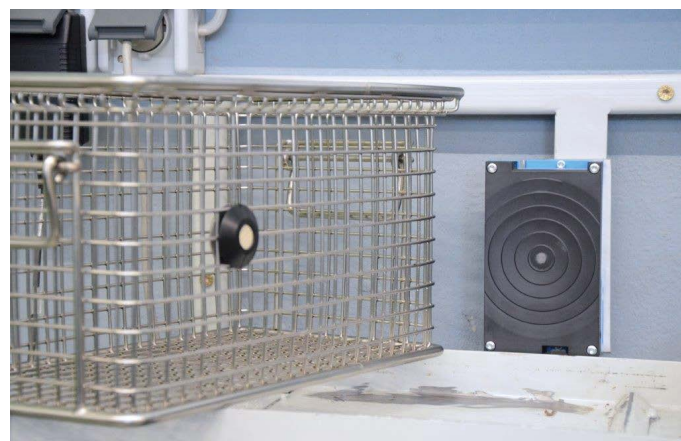
oben: top MES im Einsatz unten: Schreib-/Lesestation für RFID-Datenträger
