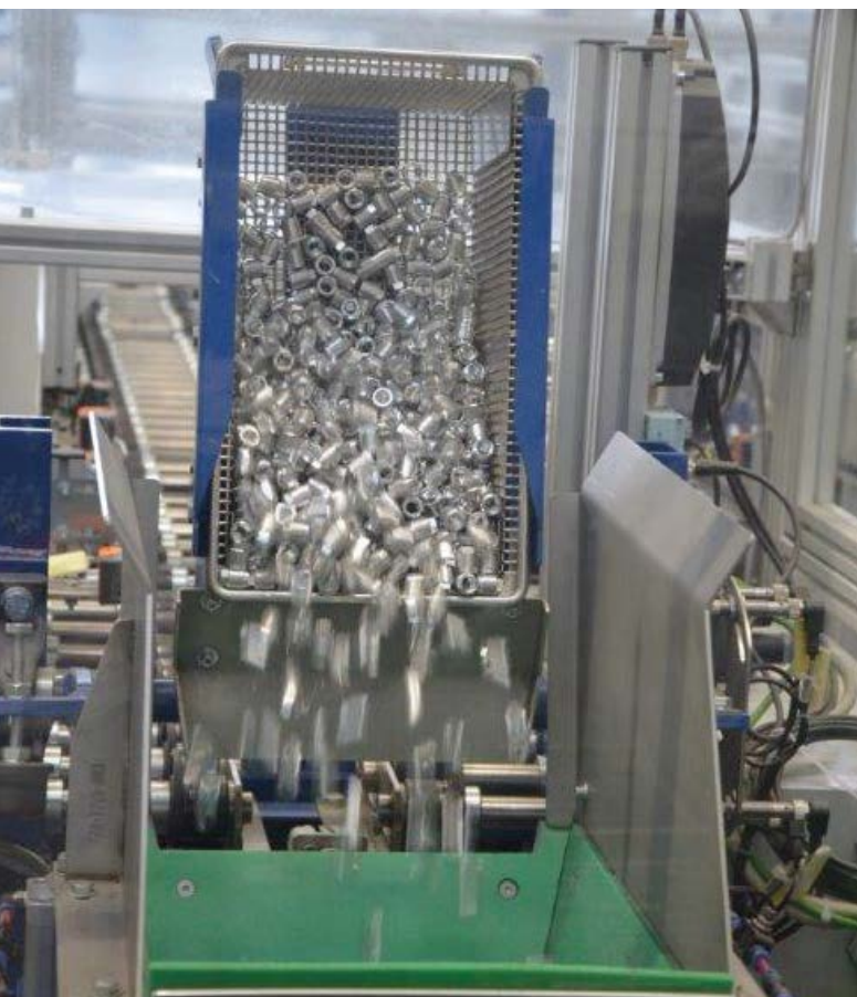
Die gereinigten Bauteile werden automatisch gewogen
